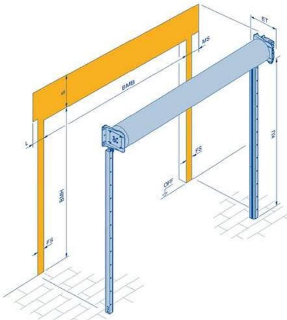
2. Porte ad avvolgimento rapido. Porte ad avvolgimento rapido con Struttura metallica perimetrale di irrigidimento in lamiera 15/10 preverniciata bianco/grigio (a richiesta in acciaio inox 304/316) in profilato adatto al supporto ed al contenimento del manto di chiusura dotata di profilo in alluminio giallo con lato esterno dotato di spazzolino da 40mm e lato interno con spazzolino da 60mm a protezione del telo durante la manovra.
