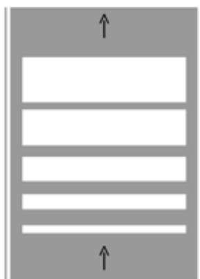
Sulla base delle indicazioni progettuali ovvero della Direzione Lavori, i sistemi di rallentamento ad **effetto acustico** saranno realizzati mediante irruvidimento della pavimentazione stradale ottenuta con la scarificazione o incisione superficiale della stessa o con l'applicazione di strati sottili di materiale in rilievo in aderenza, eventualmente integrato con dispositivi rifrangenti. Tali dispositivi possono anche determinare effetti vibratorii di limitata intensità.
